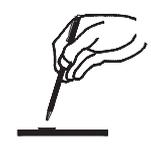
Данные переключатели расположены в углублении, чтобы избежать случайного нажатия. Для нажатия используйте, например, стержень ручки или другой тонкий предмет. Нажмите кнопку "AUX REVERSE", чтобы направить микс через выходы групп и мастер-выходы на сценические мониторы, при этом уровень можно контролировать с помощью соответствующих фейдеров. Нажмите кнопку "LR SUM MONO", чтобы послать сигнал, идущий после PFL/AFL, на сценический монитор звукорежиссера.
