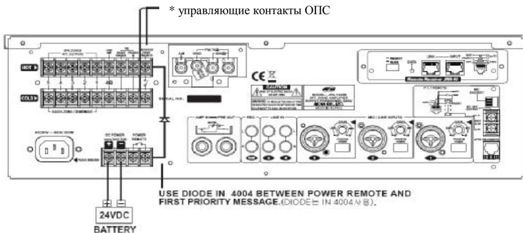
\* Схема сверху приведена для аварийной ситуации, такой как пожар. Запишите голосовое сообщение в блок сообщений JDM-10A (DIGITAL MESSAGE) (ячейка M6). Установите переключатель MS802 на плате PCB JRR-10 в положение OFF, так чтобы не передавать аварийное сообщение через JRC-10. Это делается с тем, чтобы исключить ложную тревогу при работе с дистанционным контроллером (JRC-10).
