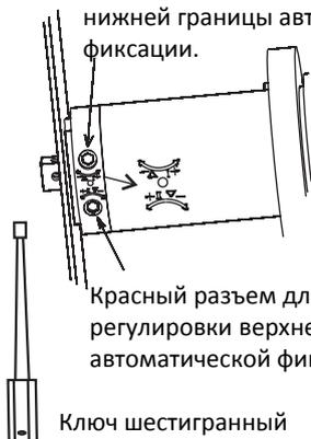
Красный разъем для регулировки верхней границы автоматической фиксации.
